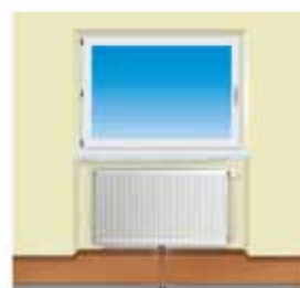
Mitte Heizkörpernische ist Mitte Heizkörper
